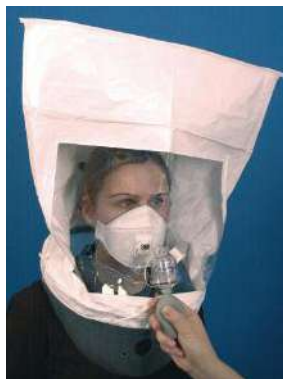
Fig. I.4. Test de ajuste cualitativo (Fuente: 3M)
