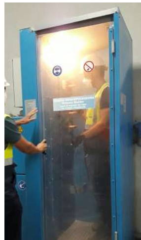
Fig. 6.1. Cabinas de limpieza de personal (Fuente: INS)
