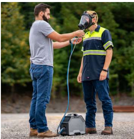
Fig. I.7. Test de ajuste cuantitativo por presión negativa controlada (Fuente: OHD)
