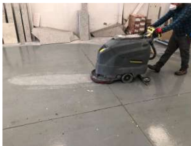
Fig. 6.3. Fregadora de suelos en marmolería (Fuente: INS)
